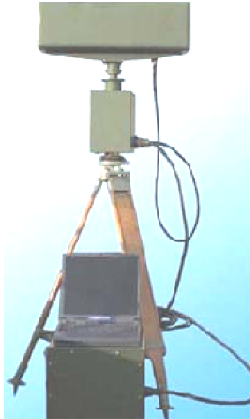
Rys. 2 Radar detekcji ruchu (źródło: www.pit.gda.pl )
