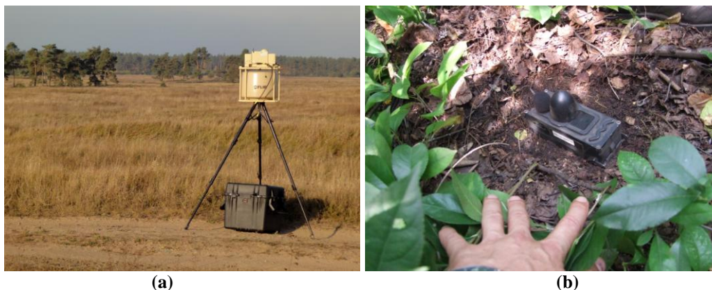
Rys. 3. Elementy WSS: (a) wyośna głowica zintegrowana z MRDR, (b) czujka akustosejsmiczna
